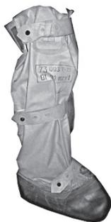
**Защитные чулки** делают из прорезиненной ткани. Подошвы их усилены брезентовой или резиновой осоюзкой. Чулки с брезентовой осоюзкой имеют две или три тесемки для крепления к ноге и одну тесемку для крепления к поясному ремню; чулки с резиновой осоюзкой крепятся на ногах при помощи хлястиков, а к поясному ремню - тесемкой. Вес защитных чулок 0,8-1,2 кг. При действиях на зараженной местности защитный плащ используется в виде комбинезона.
